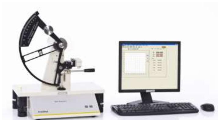
图 8 SLY-S1 撕裂度仪
