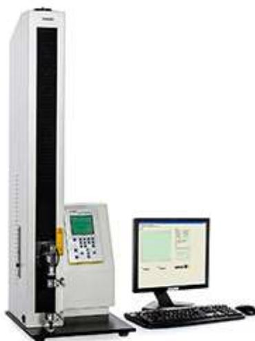
图7 XLW(PC)智能电子拉力试验机
