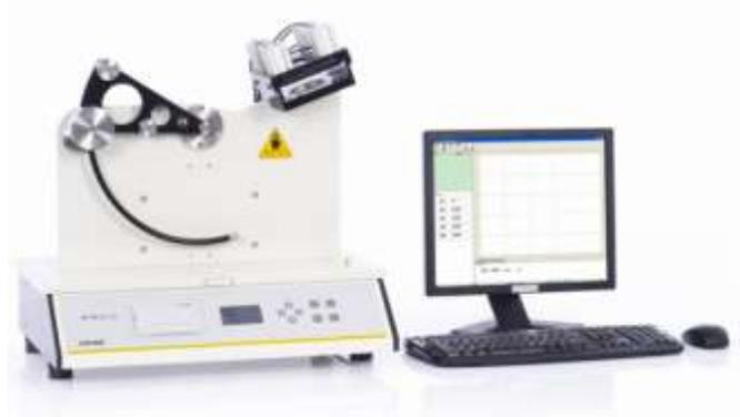
图 10 FIT-01 薄膜冲击试验仪
